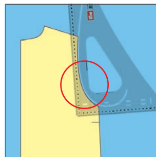
шаговое скругление на передней и задней половинках брюк
